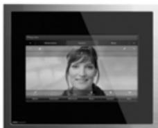
Der PC-basierte Gira Control 9 Client kann über das Gira TKS-IP-Gateway direkt als Wohnungsstation eingesetzt werden. Hierzu wird eine spezielle Software, der TKS-Communicator, installiert. Für die audiovisuelle Kommunikation sind Lautsprecher und Mikrofon integriert, ebenso eine Farbkamera für zukünftige Anwendungen. Über den Touchscreen mit einer Bilddiagonalen von 22,9 cm (9") hat der Anwender auf dem Gira Control 9 Client alles im Blick und im Griff.
