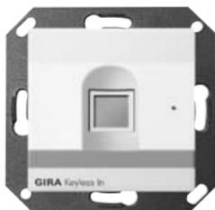
Die Fingerprint-Leseinheit ermöglicht die Realisierung einer Zutrittskontrolle auf Basis der biometrischen Merkmale des menschlichen Fingers. Mittels Hochfrequenz-Technologie wertet sie die untersten Hautschichten des aufgelegten Fingers aus. Darum funktioniert der Zugang auch bei kleineren Verletzungen an der Hautoberfläche oder leicht verschmutzten Fingern.
