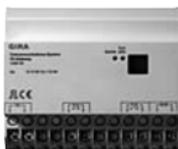
Das TKS-TK-Gateway ist die Verbindung zwischen dem Gira Türkommunikations-System und dem Telefonanschluss.
