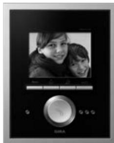
Das 14,5 cm (5,7") große TFT-Farbdisplay bietet mit einer Auflösung von 640 x 480 Pixel eine hervorragende Bildqualität.
