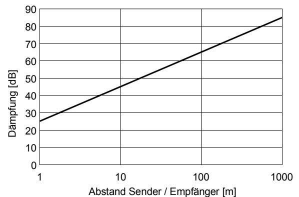
Bild: Dämpfung des Funksignals im freien Raum
