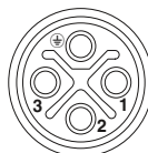
Polbild Buchse M12, 4-polig, S-kodiert, Ansicht Buchsenseite
