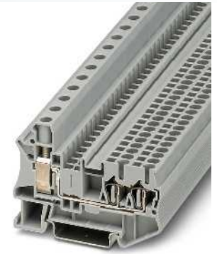
57 A, Einspeiseklemme, 4 Abgänge 2,5 mm 2
