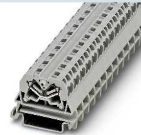
30 A, Durchgangsklemme, seitliche Leitereinfuhrung, 4 Anschlusse
