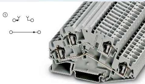
4 (6) mm 2 , 34 A, Doppelstockklemme mit Trennzone
