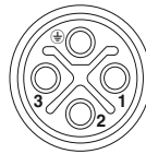
Polbild Buchse M12, 4-polig, S-kodiert, Ansicht Buchsenseite
