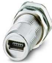
Mini-B USB, M12-Befestigungsgewinde, Wellenlöt-Kontakte, integrierter Schirmkontakt
