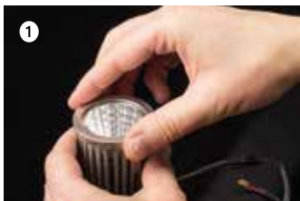
Schrauben Sie den Reflektor ab.
