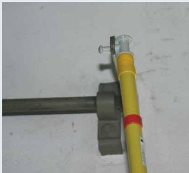
Aufgeschraubter Schaltstangenkopf auf Isolierstange IS SK zum Schalten eines Lasttrennschalters.
