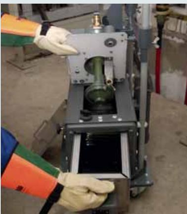
Nach dem Herauskippen der Förderpumpe aus der HT-Masse kann der Öl-Behälter zum Nachbefüllen aus dem NFG MS entnommen werden.
