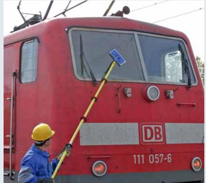
Scheibenreinigung einer E-Lokomotive mit dem Isolierstangen-Set.
