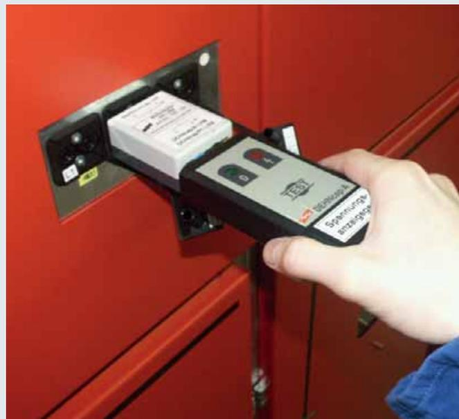
Der HR-LRM Messadapter ermöglicht die Verwendung eines LRM-Anzeigergerätes an einer HR-Messbuchse.
