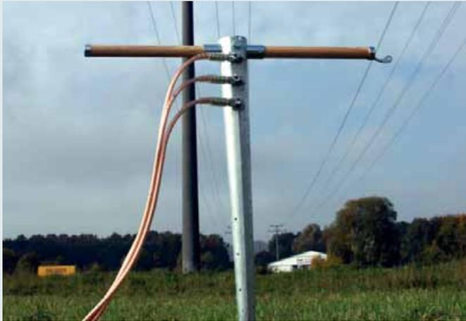
Erdungsrohr mit montierter Erdungsschiene und Erdungsseilen.
