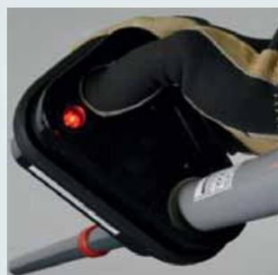
Vor dem Prüfen auf Spannungsfreiheit ist die Funktionskontrolle durchzuführen. Beim Drücken der Taste "TEST" blinkt die rote Lampe.
