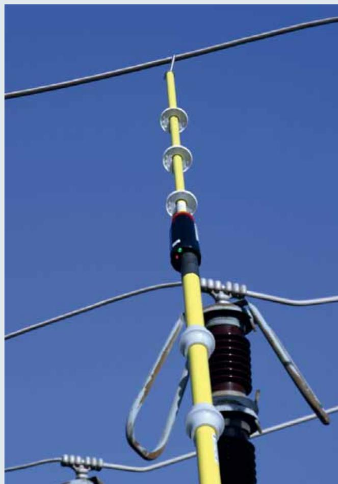
Spannungsprüfer PHE III an einer Freiluftstation 110 kV.
