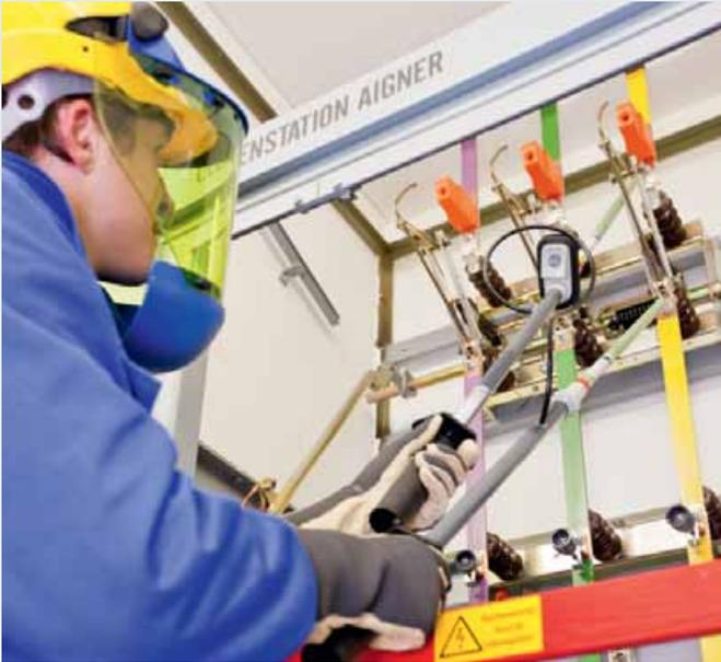
Zweipölgiger Phasenvergleicher PHV mit grünem Prüfspitzenpaar (15 ... 24 kV) im Einsatz an einer 20 kV-Schaltanlage.
