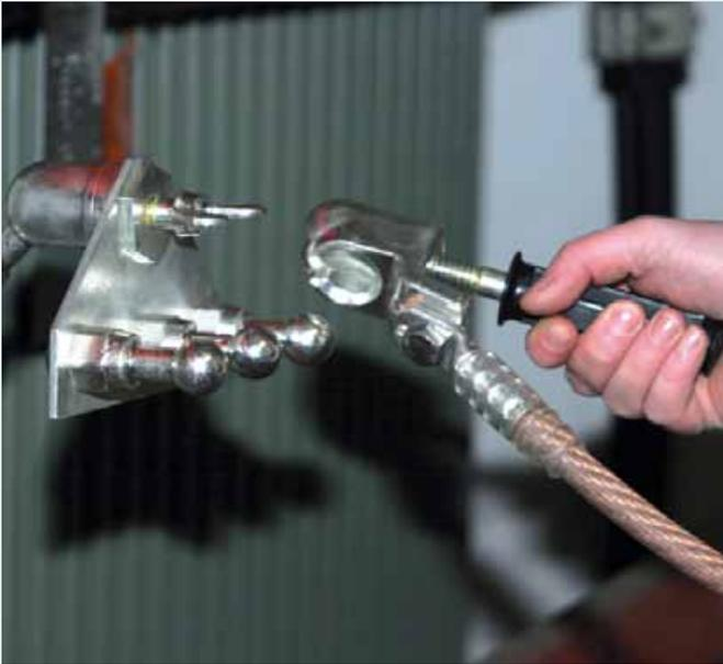
Erdanschlussplatte mit Kugelfestpunkten und Kugelkopfhabe mit Handgriff aus Kunststoff.
