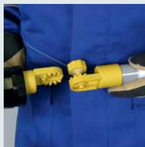
Universalzahnkupplung zum Abwinkeln des Spannungsprüfers
