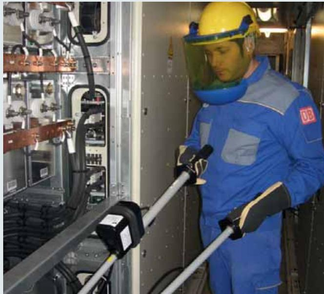
Gleichspannungsprüfer PHE/G II für Gleichstromzwischenkreise (ICE-Triebkopf).
