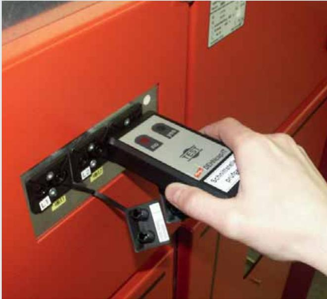
Schnittstellenprüfgerät DEHNcap/IT ermöglicht die Wiederholungsprüfung an Koppelteilen von Schaltanlagen entsprechend DIN VDE 0682-415 (IEC/EN 61243-5).
