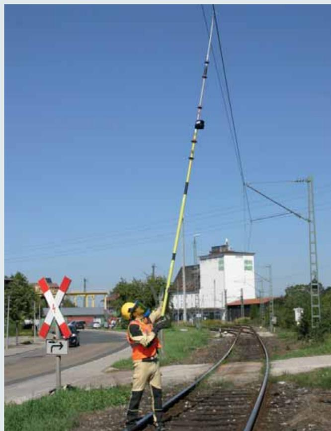
Spannungsprüfer PHE mit optischer Anzeige an einer Fahrdrathleitung der Deutschen Bahn.
