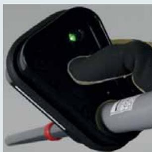
Nach dem Loslassen der Taste leuchtet die grüne Lampe. Das Gerät hat die Funktionskontrolle ordnungsgemäß durchgeführt und ist somit betriebsbereit.
