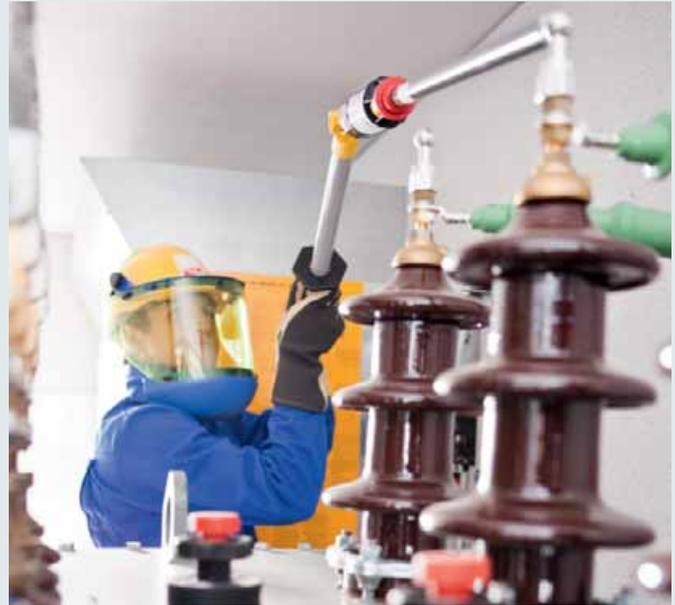
Prüfkopf PHE III mit Universalzahnkupplung und Isolierstange.
