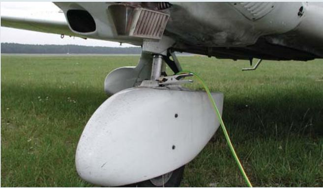
Erdungszangen zur kontrollierten Erdung/ableiten statischer Aufladung von Tankwagen, Flugzeugen, Containern und Behältern. Auch für die Anwendung in explosionsgefährdeten Bereichen geeignet.
