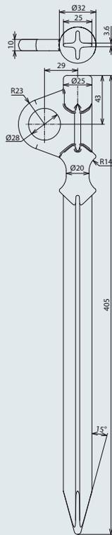
Ankerpfahl zum Abspannen z. B. von Stangenteilen und Lattenscheren beim Überbau von Fernmeldekabeln
