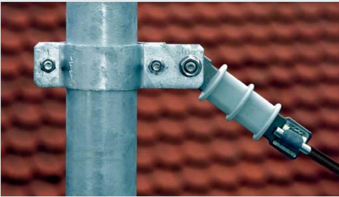
Zum indirekten Anschluss eines Freileitungs-Dachständers an die Äußere Blitzschutzanlage gemäß DIN VDE 0211
