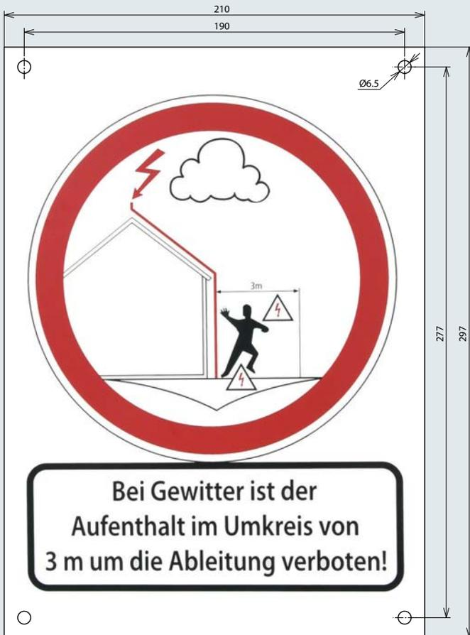
Hinweisschild bei Gefahr von Schritt- und Berührungsspannung für Lebewesen nach der Anforderung DIN EN 62305-3 (VDE 0185-305-3)
