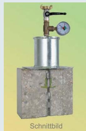
**Bild 2:** Prüfaufbau mit Anschluss für die Druckwasserprüfung
