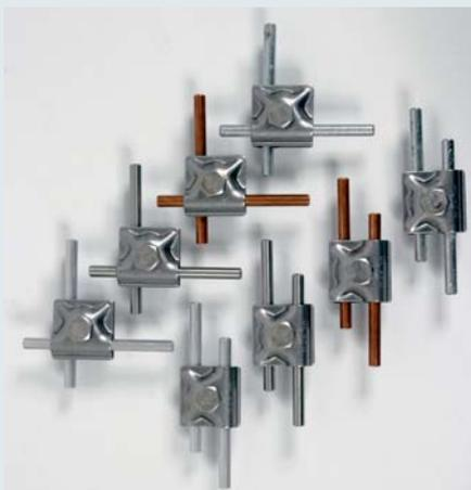
**Bild 4:** Prüfkombinationen für MV-Klemme (Parallel- und Kreuzanordnung)
