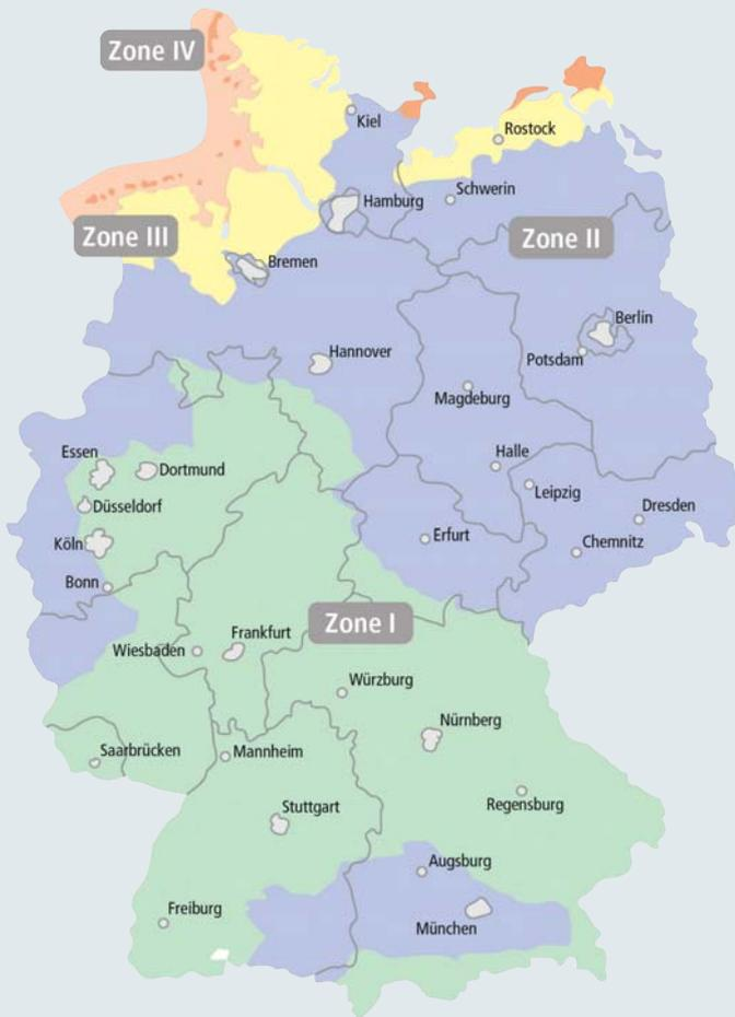
**Bild 1:** Windlastzonen in Deutschlands und zugehörige Werte für Staudruck und maximale Windgeschwindigkeit
