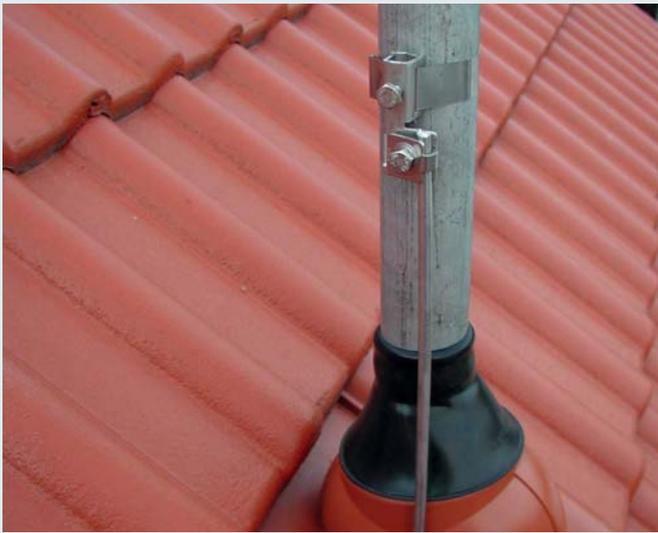
Bandrohrschelle für den Blitzschutz-Potentialausgleich von Rohren (z. B. Antennenstandrohren) nach DIN EN 62305-3 (VDE 0185-305-3) mit stetig verstellbarem Spannband, für 1 oder 2 Leiteranschlüsse und Durchgangsverdrahtung geeignet
