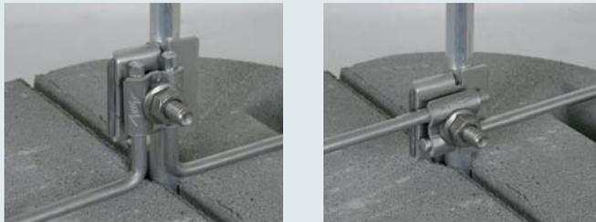
FangStangenklemme zum Verbinden von Fangstangen/-spitzen mit einer oder zwei Leitungen bei zwei Anschlussleitungen bessere Aufteilung des Blitzstromes und somit eine Reduzierung des Trennungsabstandes mit spezieller Druckscheibe für den Anschluss längs und quer
