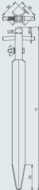
Erdungsspieß zur Erdung beweglicher Objekte wie z. B. Fahrzeuge, Stromerzeuger
