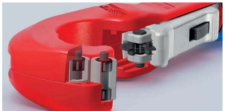
Das Schneirad und die vier Führungsrollen laufen dank hochwertiger Nadellager beim Schneiden praktisch ohne störende Reibung – schneidet Edelstahlrohre besonders leicht
