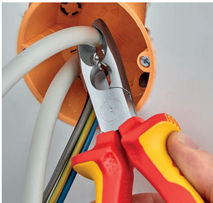
Rundschnaide mit Tiefenbegrenzung: zum leichten und beschädigungs- freien Abmanteln
