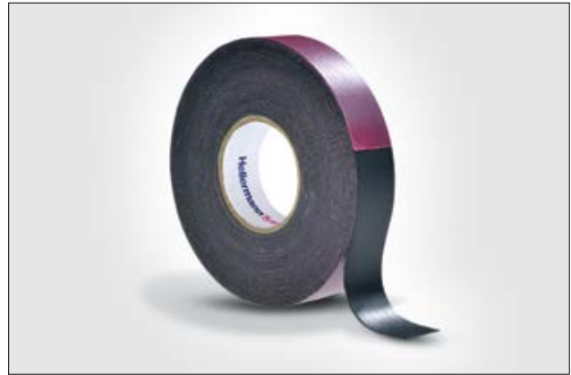
HelaTape Power 600 ist ein selbstverschweißendes Kautschukband für den Niederspannungsbereich.
