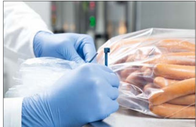
Detektierbare und wiederverwendbare Kabelbinder für zeitweisen Verschluss.
