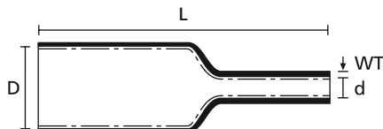
Schrumpfschlauch, Schrumpfrate 4:1 mit Innenkleber
