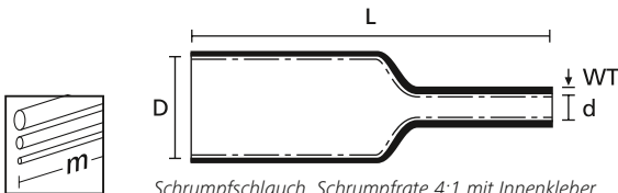
Schrumpfschlauch, Schrumpfrate 4:1 mit Innenkleber
