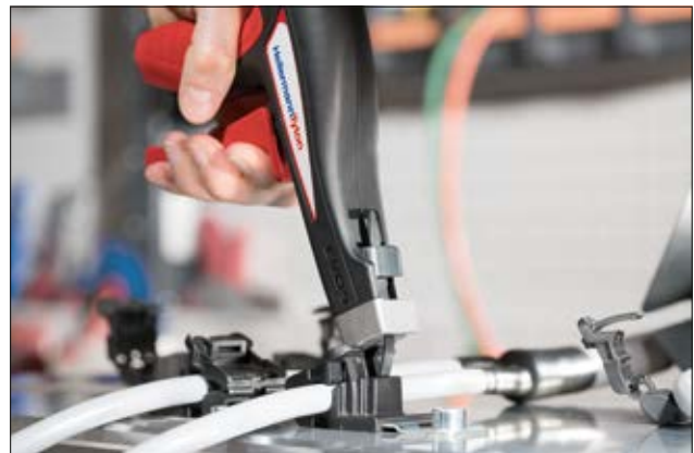
Anzugshilfe ermöglicht definierten Anpressdruck.
