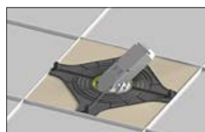
3. Einsetzen des Einbaustrahlers durch die zugeschnittene Montageöffnung.
