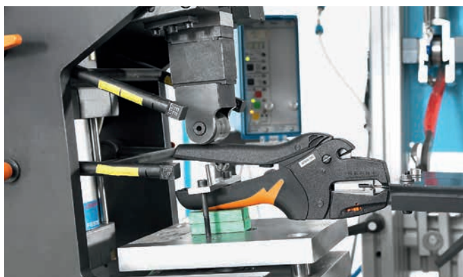
Lebensdauerprüfung der stripax® im Weidmüller Labor
