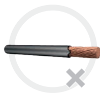
Isolierung nicht einwandfrei eingeschnitten
