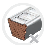
Rissbildung oder Aufplatzen an den Seitenkanten
