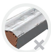
Rissbildung an den Abdrücken des Crimpstempels
