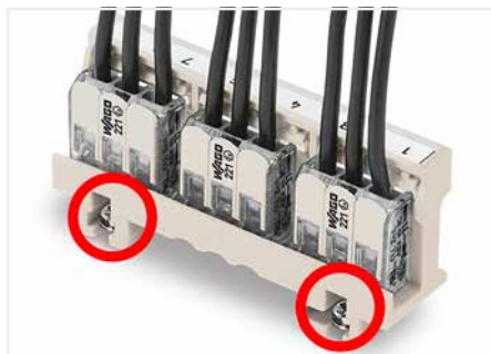
Einbauweise 440 V Schraubbefestigung des Adapters mit nichtleitfähiger Schraube
