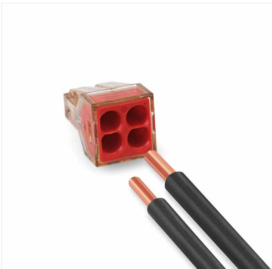
Lösen: Leiter festhalten, Klemme durch Hin- und Herdrehen mit leichtem Zug vom Leiter ziehen.
