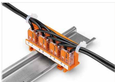
Zugentlastung durch Kabelbinder am Adapter, quer zur Klemmenanschlussrichtung; Klemmstellenkennzeichnung durch Beschriftungsstreifen (210-334)
