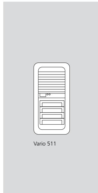
Durch Einsatz eines Vario-Adapters VA/GU 5... kann ein bereits eingeputztes Unterputzgehäuse GU 5... auf das neue Siedle Vario-System umgerüstet werden.
