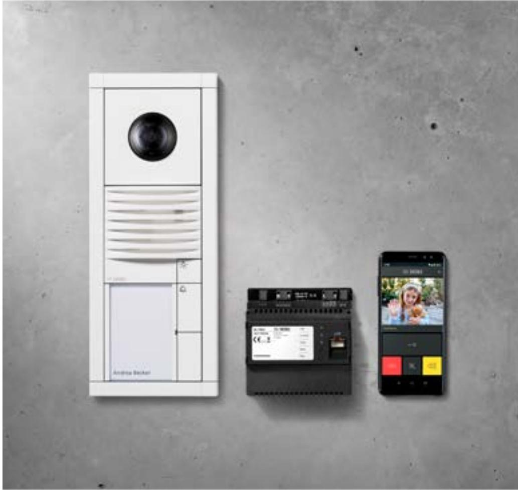
Mit der Video-Türstation des Vario-Sets Smart Gateway haben wir ein attraktives Paket geschnürt. Ihr schlichtes Weiß passt zu nahezu allen Fassaden. Der Erfassungswinkel der Kamera von 130°/100° (horizontal/vertikal) sorgt für erstklassige Sicherheit am Eingang. Die Anbindung an das lokale IP-Netz erfolgt über das Smart Gateway, mobile Türkommunikation über die Siedle App.
