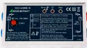
Der Prüfadapter dient, in Verbindung mit einem Spannungsmessgerät, zum Prüfen von Schweißgeräten nach Norm EN 60974-4:2007
