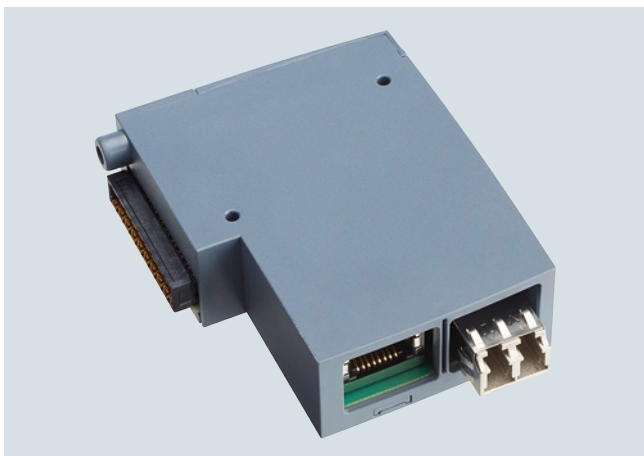
SIMATIC BusAdapter BA LC/RJ45 für den Einsatz als systemintegrierter Medienkonverter von Kupfer (RJ45) auf Glasfaser (LC)
