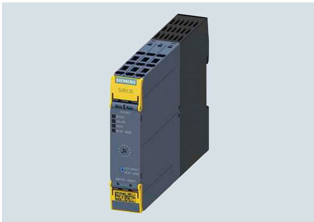
Motorstarter 3RM13 mit Wendefunktionalität, elektronischem Überlastschutz und sicherheitsgerichtetem Abschalten
