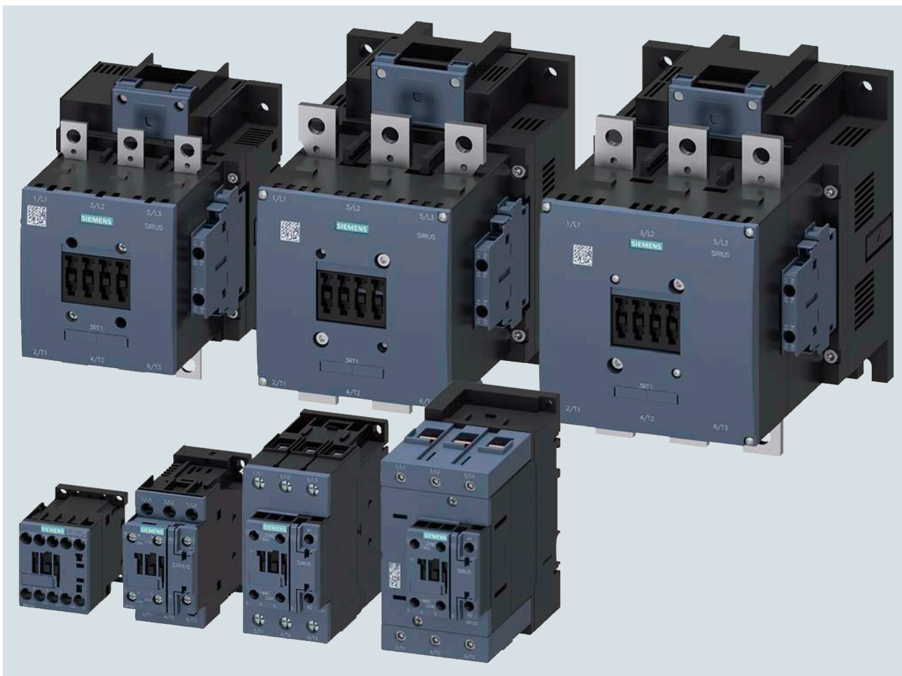
Schütze mit Schraubanschlüssen: 3RT2 (Baugrößen S00 bis S3) und 3RT1 (Baugrößen S6 bis S12)
