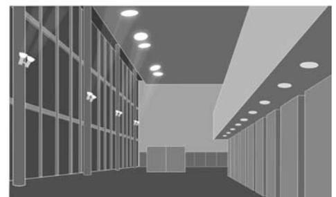
**Voutenleuchten:** Vouten sind rinnenförmig z.T. stukkatierte Ausbildungen in oder an Decken oder Wänden für eine indirekte Raumbelichtung. Leuchtmittel: Leuchtstofflampen oder LED.
