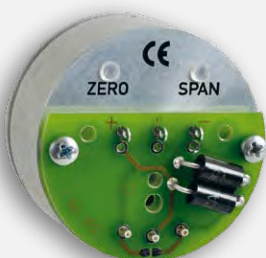
Anschlussprint mit Trans-Zorb-Diode
