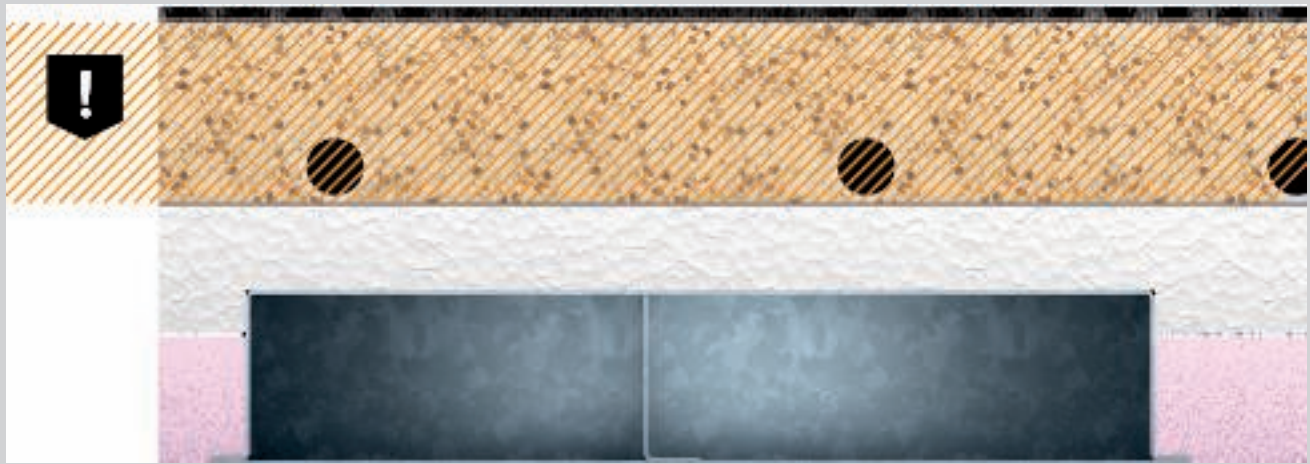
Estrichnenndicke beim estrichüberdeckten Kanalsystem EÜK
