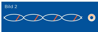
Bei Erwärmung über  $+120^{\circ}\text{C}$  werden die kristallinen Zonen aufgelöst (Bild 2). In diesem Zustand ist das Material elastisch und kann mechanisch expandiert werden.
