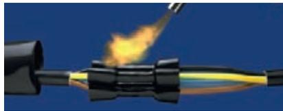
Die mit Heißschmelzkleber beschichteten Innenmuffen werden über die Verbinder geschoben und aufgeschrumpft. Dabei schmilzt der Kleber und gewährleistet eine zuverlässige Abdichtung gegen das Eindringen von Wasser.
