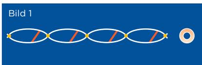
Nimmt man zB. einen Schlauch und bestrahlt ihn, werden chemische Bindungen - Vernetzungen - zwischen den Molekülketten hergestellt. Bild 1 zeigt einen einfachen Ausschnitt zweier miteinander vernetzter Molekülketten.
