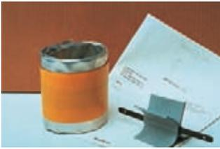
Das RDSS System besteht aus einer flexiblen Abdichtmanschette RDSS, die beidseitig mit Dichtmassestreifen beschichtet ist. Nach Bestreichen der Dichtmassestreifen mit Gleitmittel wird die Abdichtmanschette RDSS einfach um das Kabel gewickelt und in das Rohr oder die Kernlochbohrung geschoben
