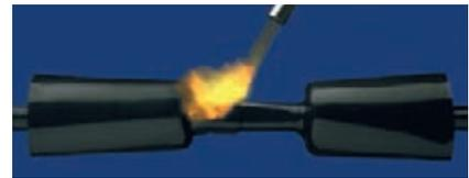
Zum Schluss wird die Außenmuffe positioniert und ebenfalls geschrumpft. Auch hier sorgt der Heißschmelzkleber für eine zuverlässige Abdichtung zwischen Außenmuffe und Kabelaußenmantel.
