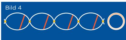
Beim Abkühlen des Schlauches in seiner expandierten Form unter  $+120^{\circ}\text{C}$  bilden sich die kristallinen Zonen zurück und fixieren den Schlauch in expandiertem Zustand (Bild 4). Diese Form ist die Lieferform wärmschrumpfender Materialien.
