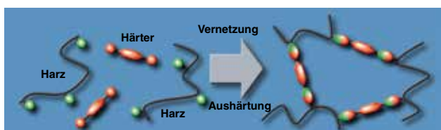
Bild 1 Schematische Darstellung der Reaktion bei Polyurethanen
