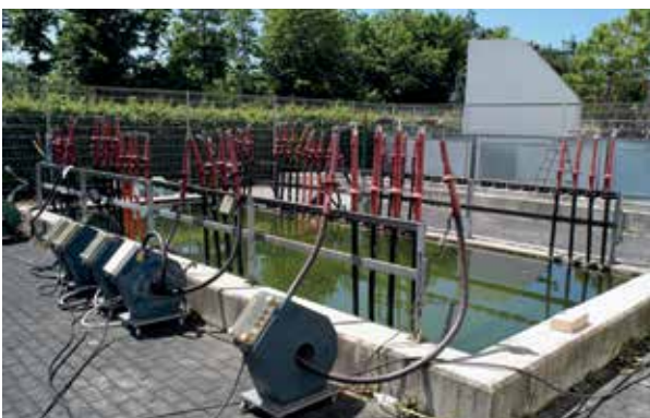
Prüfanlage für Kabelgarnituren im Labor in Ottobrunn.
