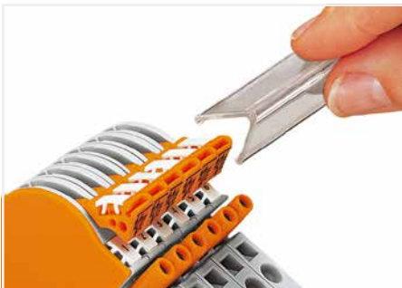
Auf Trennhebel aufrastbare Verriegelungskappe, für 1 bis 8 Trennhebel, einsetzbar als: a) als mechanische Verriegelung zum mehrpoligen Schalten, oder b) als Schutz für Beschriftungsschilder
