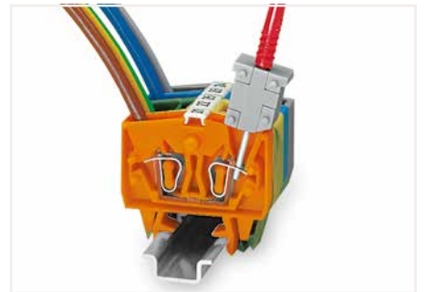
Prüfen über CAGE CLAMP®-Anschluss an der Stromschiene – möglicher Nennstrom 6 A; durch CAGE CLAMP®-Betätigung können einzelne Prüfkontakte geklemmt werden. Die maximale Prüfspannung beträgt 400 V.
