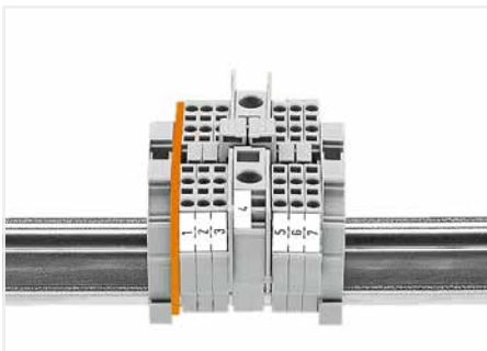
Brücken mit Reduzierbrückern von Reihenklemmen 6 mm 2 (Serie 282) auf Reihenklemmen 1,5 mm 2 (Serie 279)
