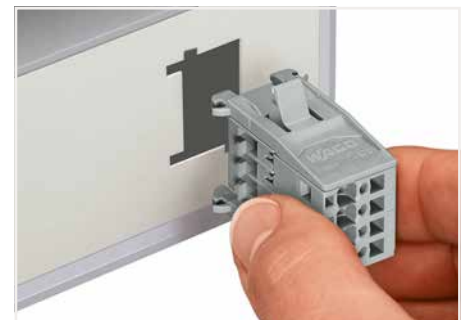
Stiftleiste; mit Snap-In-Flanschen (769-604/005-000) in den Blechausschnitt stecken.
