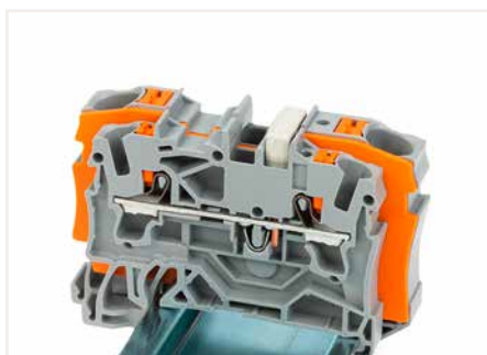
Reduzierbrücker (2006-499): von 6/4 mm 2 (Serien 2206/2204) auf 4/2,5/1,5 mm 2 (Serien 2204/2202/2201)
