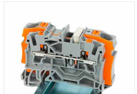
Reduzierbrücker (2006-499): von 6/4 mm 2 (Serien 2206/2204) auf 4/2,5/1,5 mm 2 (Serien 2204/2202/2201)
