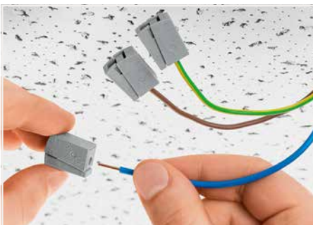
Leiter anschließen: Abisolierten eindrätigen Leiter bis zum Anschlag in die runde Öffnung hineinstecken.
