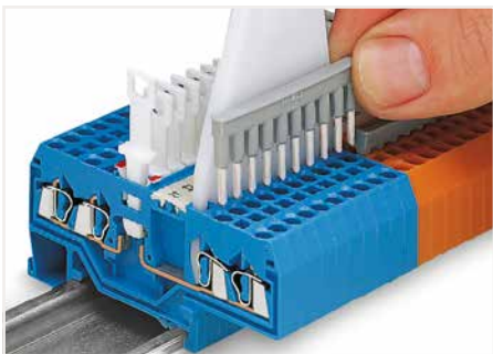
Brücken von Trennklemmen mit Frontverdrahtung mit Brückungskämmen unter Zuhilfenahme eines 10-fach-Betätigungswerkzeuges
