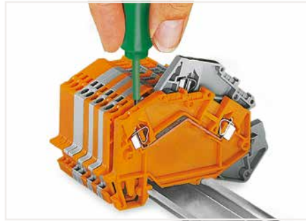
Eine Klemme aus dem Verband demontieren.
