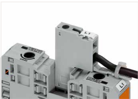
Der Potentialabgriff wird im Brückerschlitz montiert. Er kann mit einer Zugentlastungsplatte versehen werden.
