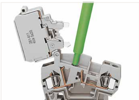
Rückspannungsprüfung ausgangsseitig an der separaten Prüfföffnung
