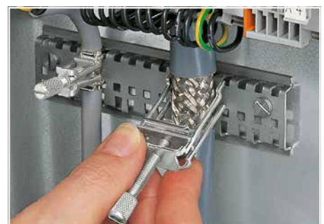
Zum Demontieren eines Schirmklemmbügel die Rändelschraube über den Druckpunkt hinaus aufdrehen und Klemmbügel unter leichtem Abkippen entnehmen.
