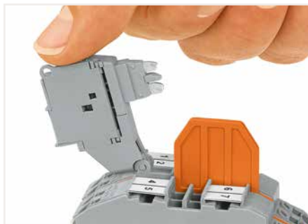
Die Doppelstock-Sicherungsklemme mit schwenkbarem Sicherungshalter (2002-2611, grau) ist kombinierbar mit den Trenn-, Basis-, Durchgangs- und Schutzleiterklemmen. Der Sicherungshalter ist auch mit einer LED-Defektanzeige erhältlich (z. B. 2002-2611/1000-541 für 12 ... 30 V).
