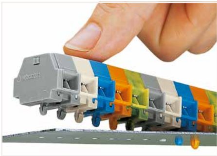
Klemmenleiste; mit Rastfüßen; Einrasten in Rastlöcher
