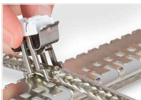
Schirmklemmbügel auf der spezialgelochten Tragschiene (790-145) aufsetzen. Finger nicht unter den Bügel legen und dann die Feder entspannen!
