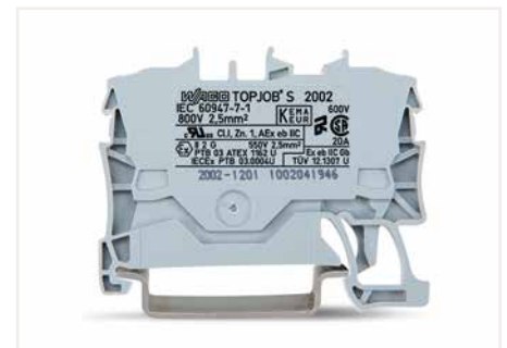
Beschriftungsbeispiel Die Aufschrift auf den Klemmen enthält das Herstellerzei- chen, die Seriennummer, die Zündschutzart Ex e II, die Zulassungsnummer, die Zulassungsdaten sowie den Namen des Prüfinstitutes.
