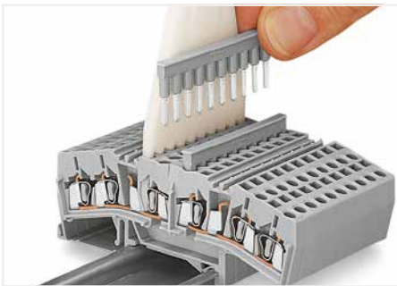
Verwendung als Potentialvervielfacher Einsetzen eines 10-fach-Brückenskamms (nur im inneren Bereich möglich!)
