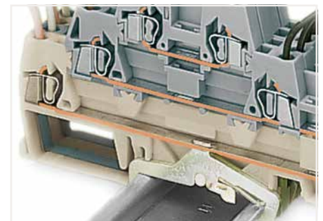
Die Schutzleiter- oder Schirmleiterklemmen im Erdschloss haben einen Kontaktfuß mit automatischer Kontaktierung zur Trag-/Sammelschiene. Der über den Verdrahtungsebenen stehende Beschriftungsträger wird während der Verdrahtung automatisch zur Seite gebogen. Die in der Höhe versetzt angeordneten Beschriftungsaufnahmen für WMB-Beschriftungsschilder sind den „Stockwerken“ eindeutig zugeordnet. Bei einer Klemmenbreite von nur 5 mm ergibt sich ein effektives Teilungsmaß für Klemmen gleicher oder unterschiedlicher Potentiale von nur 1,67 mm, bei einem Querschnittsbereich von 0,08 ... 2,5 mm 2 .
