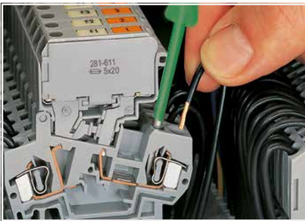
CAGE CLAMP®-Anschluss Leiter anschließen. Bei Verwendung der Nennquerschnitte mit Aderendhülsen ist jeweils der nächst kleinere Leiterquerschnitt zu wählen.
