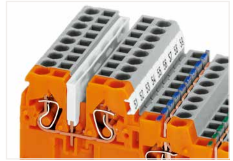
Brücken der Signalebene durch Einsatz der isolierten Kammbücker – Serie 870 Je nach Anwendung 2- bis 9-fach LED-Ausführung nicht brückbar!
