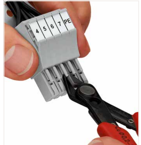
Federleiste kodieren, gewünschte Kodier Nase mittels geeignetem Werkzeug von der Federleiste abtrennen.
