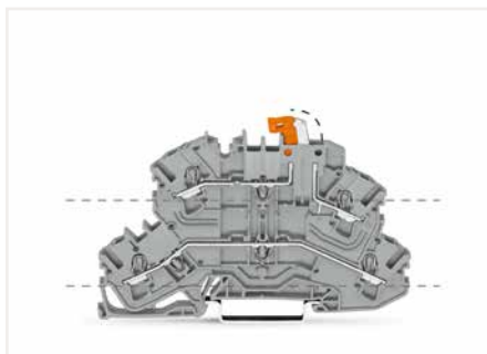
Die Doppelstock-Trennklemme mit schwenkbarem Trennmesser (2002-2671) ist auf der unteren Etage als Durchgangsklemme und auf der oberen als Trennklemme zu verwenden. Neben der Trenn- und Messfunktion bietet die dazu passende Doppelstock-Basisklemme (2002-2667) zudem eine Schutzleiterfunktion.
