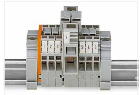
Brücken mit Reduzierbrückern von Reihenklemmen 16 mm 2 (Serie 283) auf Reihenklemmen 4 mm 2 (Serie 281)
