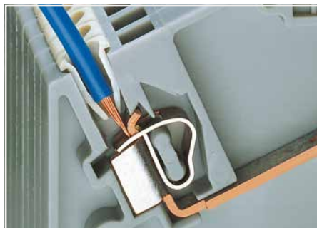
Isolierungsstopp Kein Eindringen der Leiterisolierung in die Klemmstelle! Lieferbar für Klemmen bis 4 mm 2
