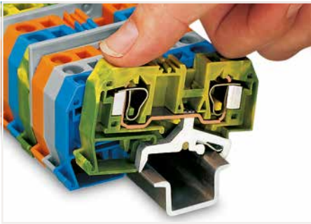
Aufrasten einer Schutzleiterklemme auf die Tragschiene; dabei wird die Kontaktierung zur Tragschiene ohne zusätzliche Handhabung automatisch sichergestellt.
