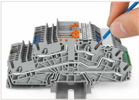
Leiter anschließen – direkt stecken. Eindrätige Leiter lassen sich bis zu einem Querschnitt über und mindestens zwei Querschnittstufen unter dem Nennquerschnitt direkt stecken, ohne Werkzeug.
