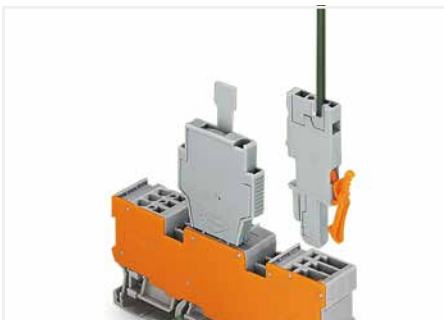
1-Leiter/1-Pin-Basisklemme; mit 2-fach-Querbrückung 1-Leiter-Federleiste; gerade* Sicherungsstecker; 6 mm breit (jede 2. Klemme) * Auch abgewinkelte 1-Leiter-Federleiste möglich!
