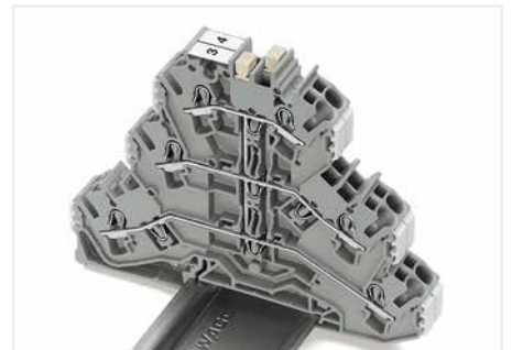
Dreistock-Vertikalbrücker (2002-493), gesteckt, zur Brückung über drei Etagen
