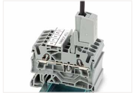
Der Prüfabgriff (2009-182) ist für die Serien 2000 bis 2016, für den werkzeuglosen Anschluss individueller Prüfleitungen bis 2,5 mm 2 geeignet.
