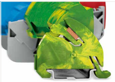
PE-Sammelschienträger (812-141) Er bietet eine Rastaufnahme für Sammelschienen (10 x 3) mm. Die Montage auf die Tragschiene 35 erfolgt komfortabel durch einfaches Aufrasten. Dabei wird automatisch der Kontakt zwischen der Sammelschiene und der Tragschiene hergestellt. Die Sammelschienenposition entspricht der mittleren Position des isolierten Sammelschienträgers.
