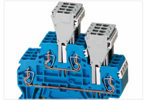
Die Steckabgriffleiste wird direkt in die Brückerschlitz der Stromschiene gesteckt, auch wenn parallel ein Kammbrücker gesteckt ist.
