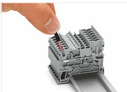
Die Push-in CAGE CLAMP® ermöglicht das direkte Stecken von eindrähtigen Leitern und feindrähtigen Leitern mit Aderendhülse.
