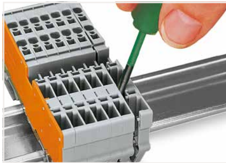
Verband mit Betätigungs Werkzeug öffnen, Klemme seitlich verschieben und über Demontageschlitz lösen.
