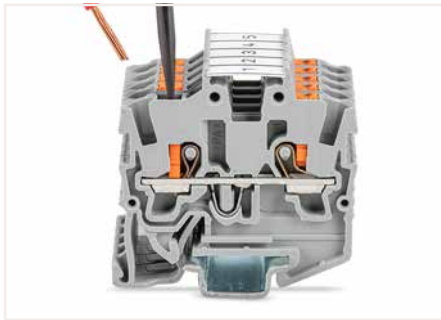
Leiter mit Betätigungswerkzeug anschließen – feindrätige Leiter
