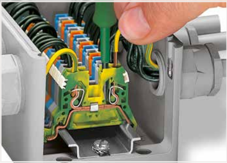
CAGE CLAMP®-Anschluss Leiter anschließen (0,08 ... 4 mm 2 „f“). Bei Verwendung der Nennquerschnitte mit Aderendhülsen ist jeweils der nächst kleinere Leiterquerschnitt zu wählen.
