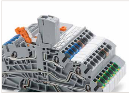
Bei Installationsetagenklempen mit interner N-Trennung können bei getrenntem N-Potential Prüfadapter in den freigewordenen Vertikalprüfschacht eingesetzt werden.
