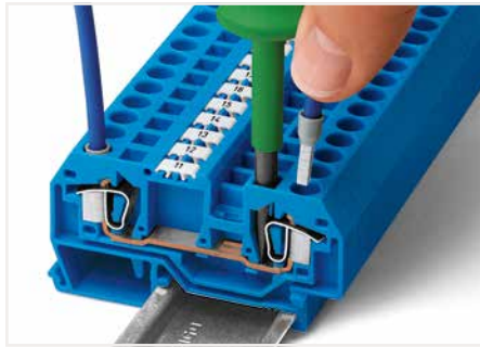
CAGE CLAMP®-Anschluss Leiter anschließen. Bei Verwendung der Nennquerschnitte mit Aderendhülsen ist jeweils die nächst größere Klemme zu wählen.
