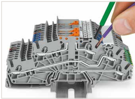
Leiter mit Betätigungswerkzeug anschließen. Beim Anschluss unbehandelter feindrätiger Leiter oder kleiner Querschnitte, die ein direktes Stecken nicht zulassen, wird zum Öffnen der Klemmfeder, wie bei CAGE CLAMP® gewohnt, das Betätigungswerkzeug in die Betätigungsöffnung gesteckt.
