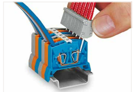
Tippkontaktierung, über die Feder des CAGE CLAMP®-Anschlusses, begrenzt den Nennstrom auf maximal 0,5 A und die maximale Prüfspannung auf 48 V; die Prüfstifte sind nicht berührungsgeschützt.
