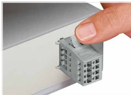
Zum Demontieren die Laschen mit einem Betätigungswerkzeug aus der Rastposition lösen und bewegliche Elemente zusammendrücken.
