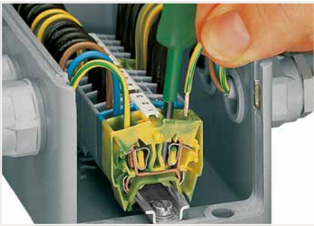
CAGE CLAMP®-Anschluss Leiter anschließen. Bei Verwendung der Nennquerschnitte mit Aderendhülsen ist jeweils der nächst kleinere Leiterquerschnitt zu wählen.
