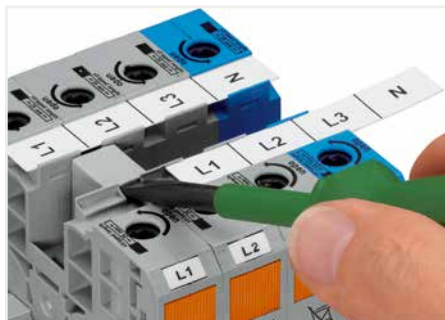
Zum Lösen der Brücken Beschriftungsstreifen seitlich verschieben.
