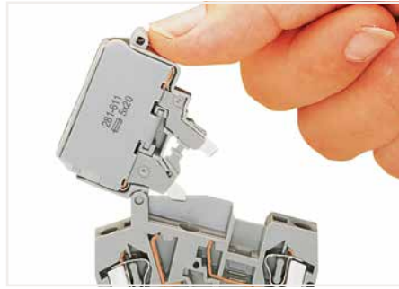
Sicherungswechsel Vor dem Auswechseln der Sicherung, Sicherungshalter in Endposition ausschwenken (Raststellung).
