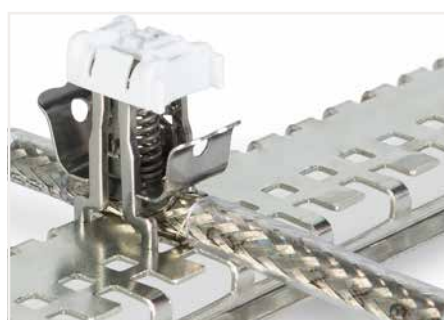
Schirmklemmbügel kontaktiert Schirmleiter und spezialgelochte Tragschiene (790-145).
