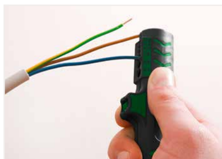
Abisolierung der Leiterisolierung
