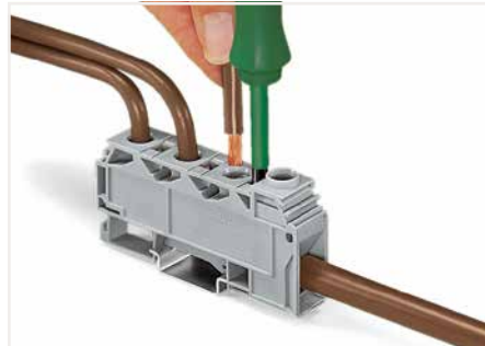
Leiter (10 mm 2 ) anschließen. CAGE CLAMP®-Anschluss, Frontverdrahtung
