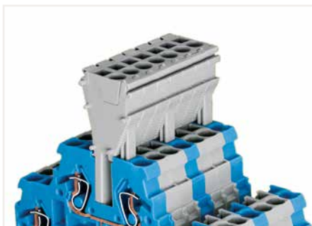
Bei Steckabgriffleisten ab 7-polig sind drei Module mit Verdrehschutz zu verwenden.
