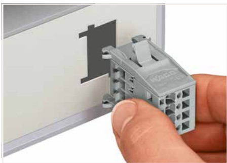
Stiftleiste; mit Snap-In-Flanschen (769-604/005-000) in den Blechausschnitt stecken.
