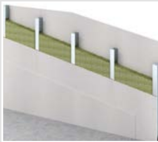
Aufbau einer F90 Metallständerwand nach DIN 4102 Teil 4
