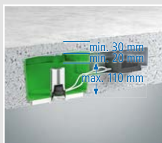
Leuchtenauswahl LED (25 W) Einbautiefe max. 110 mm.
