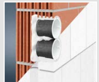
Die Brandschutzdose Unterputz kann in allen Brandschutzwänden, z.B. aus Porenbeton, Kalksandstein oder Hochlochkammernsteinen installiert werden.
