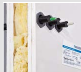
Die Rohrschotts können in einem Mittenabstand von 50 mm als Gruppe waagrecht oder senkrecht angeordnet werden.
