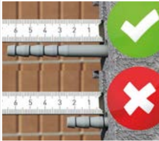
Der Dübel muss den Aufbau des Geräteträgers je nach Dübellänge um min. 30 mm überragen.
