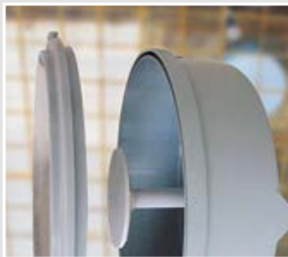
Gehäuse mit Einbausatz vormontieren.
