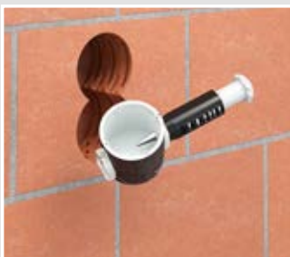
Die Brandschutzdose-Unterputz bietet 6 Einführungsmöglichkeiten für Rohre bis M25 und Leitungen bis \varnothing 11,5 mm
