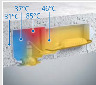
Temperatur-Profil Raumtemperatur 25 °C 50 W QR-CBC 51 (Cool-Beam mit Schutzscheibe).
