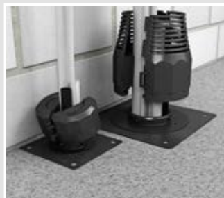
Dichtelement um die Leitungen und Rohre legen, anschließend mit dem Schottzylinder verrasten.
