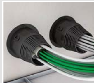
In einem Abstand von 50 mm ist eine waagerechte Anordnung der Schotts möglich.
