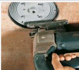
Frontteil mit einer Stichsäge öffnen.
