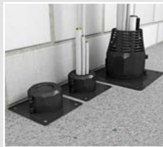
Mischbelegung von Leitungen und Rohren bis zur Vollbelegung. Auch eine Gruppenanordnung mit einem Abstand 205 mm (DS 90 / 120 mm) oder 125 mm (DS 90 / 74 mm) ist möglich.
