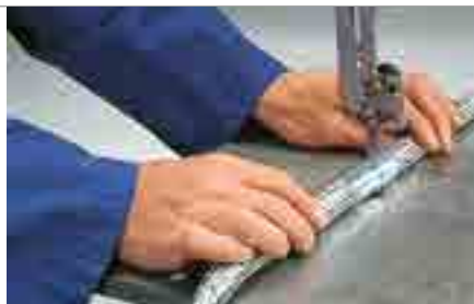
Im rechten Winkel zum Sägeblatt mit geringem Druck durchtrennen Position conduit at right angle to the band saw and carefully cut through the conduit
