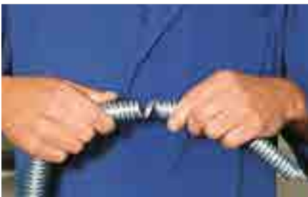
Metallschlauch kräftig nach innen verjüngend aufdrehen (eine Hand nach rechts, andere Hand nach links drehen)
