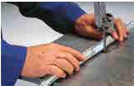
Trennstelle ca. 2–3 x mit Metall-Klebeband umwickeln Bind conduit with metal adhesive tape at the cutting position 2 or 3 times
