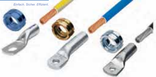
Blau-einsätze für blue connection, gelb chromatiert für Kupfer, silberfarbene für Aluminium.
