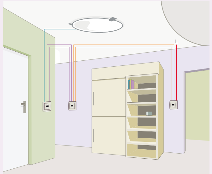
Konventionelle Elektroinstallation: mehrere Bedienstellen
