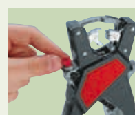
1 Querschnitt einstellen am Justierhebel
