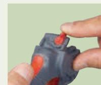
2 Querschnitt wählen mit Justierhebel
