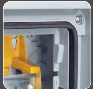
IP 65: Die passgenaue UV-beständige Dichtung gewährleistet einen sicheren Langzeit-Wasser- und Staubschutz
