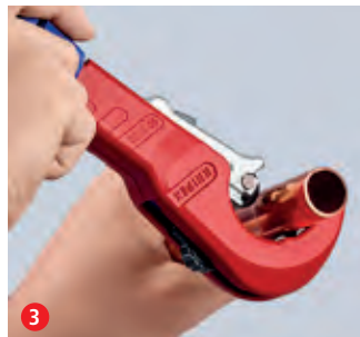
Durch Drehung schneiden und dabei mit dem ergonomischen blauen Drehknopf nachstellen ...
