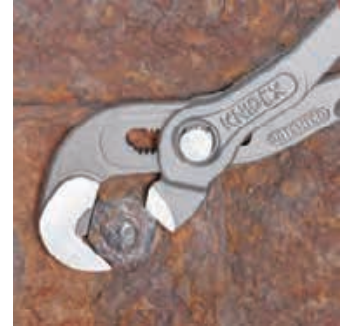
Arbeiten an verrosteter Mutter mit verrundeten Kanten
