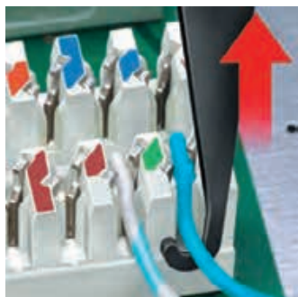
Mit integriertem Ziehhaken
