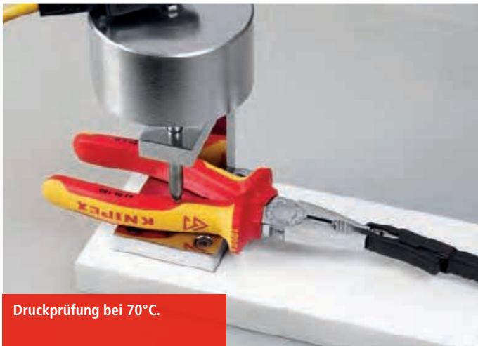
Prüfung der Haftfähigkeit der VDE-Hüllen mit 500 N.
