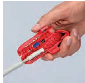
Abmanteln eines NYM-Kabels
