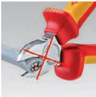
Kabelschnitt mit Seitenschneider: hoher Kraftaufwand, unsauberer Schnitt, starkes Verformen und Quetschen des Kabels
