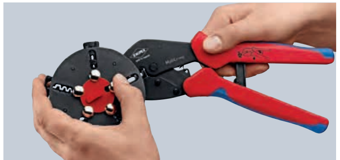
Crimpeinsatz-Wechsel: Magazinposition entsperren, Crimpeinsatz in der Zange entnehmen
