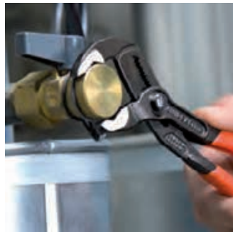
Schnelle und passgenaue Einstellung direkt am Werkstück
