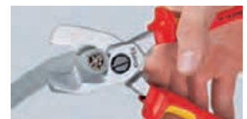
Nachschnitt: Nachdem der Mantel des Kabels im vorderen Profil durchgeschnitten wurde, werden die Leiter im hinteren Profil durchtrennt. Vorschnitt vorn, Nachschnitt hinten – so schneidet es sich leichter.
