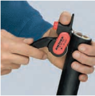
Ansetzen des Werkzeugs für Längsschnitt
