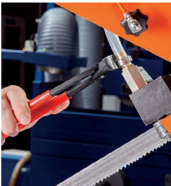
Abdichten Fluidschlauch an Stutzen mittels Seiten-Pressnase
