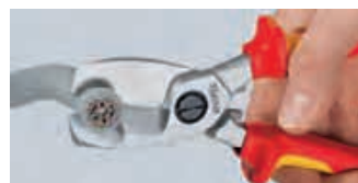
Vorschnitt: Durch Einsatz der vorderen Schneide zum Schneiden des Isoliermantels bei größeren Kabeldurchmessern bleibt eine ergonomische Griffweite erhalten.
