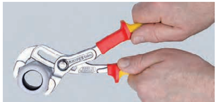
Schnelleinstellung am Werkstück ohne Druckknopfbetätigung
