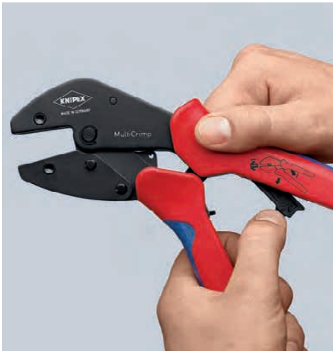
Wechselposition: Ausklappen des Service-Hebels für parallele Backenstellung
