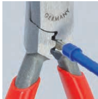
Crimpen 0,5 bis 2,5 mm 2
