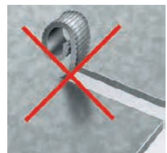
Ausklinken ohne Spanbrecher
