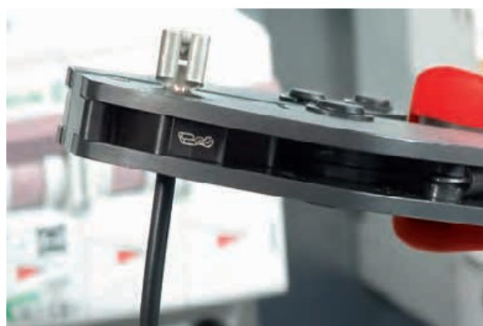
Gut sichtbare Kennzeichnung der Crimpeinsätze mit Piktogrammen
