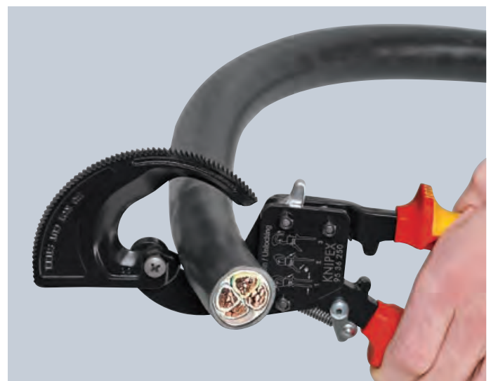
Ratschenprinzip und Zweigang-Zahnkranz-antrieb für kraftsparendes Schneiden
