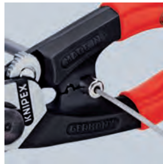
Anpressen der Endhülse an die Bowdenhülle
