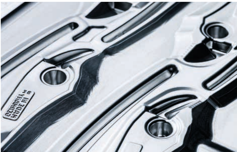
Schmiedegesenk für den Kraft-Seitenschneider mit angeschmiedeter Gelenkachse.
