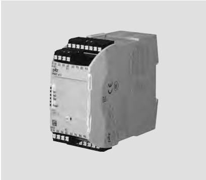
Kontakterweiterungsblock zur Kontaktvervielfältigung und Kontaktverstärkung
